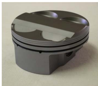
新製したDLC被覆アルミ合金製ピストン
