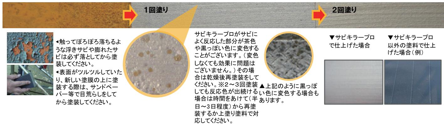
サビの奥まで浸透し、強力な錆転換機能でサビを酸化の進まない安定した状態(赤サビ→黒サビ)へと転換
