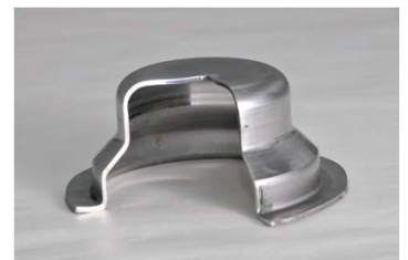
加工実例 (1ストロークによる加工)
