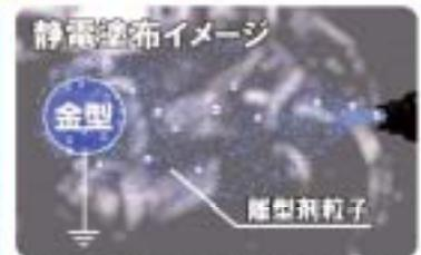
微細に霧化した離型剤に静電気を効率よく帯電。金型に接近した離型剤粒子を目に見えない第三の力とも言える静電気で付着させる方法。
